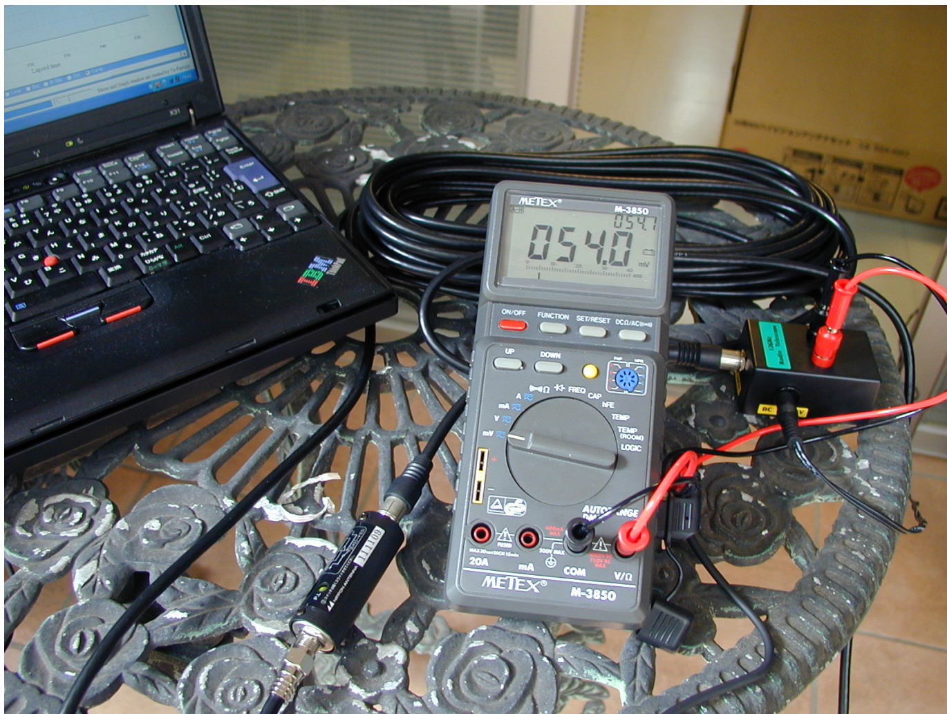
▲BS/CS アンテナと接続した太陽電波観測機器(左からパソコン, BS ラインブースター, テスター, 電源供給回路付き RF 検波器)
