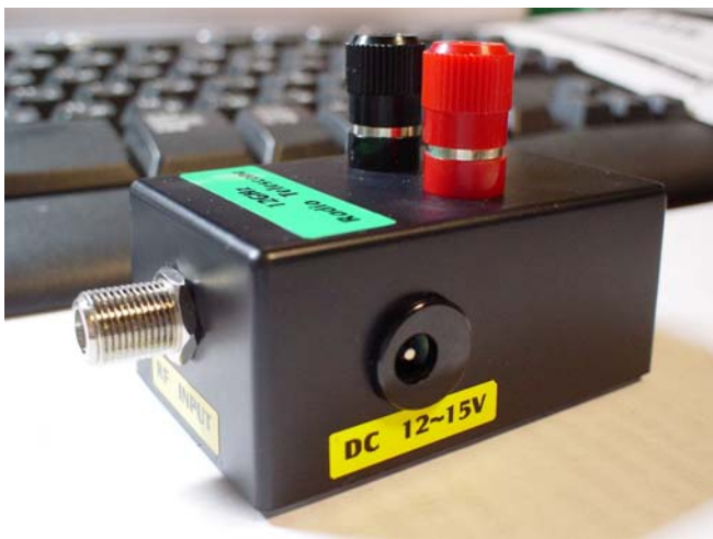
▲電源回路を内蔵した検波器の製作例(実際は 10V~16V で動作します)
