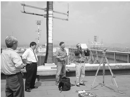
▲アシスト局（10GHz）のパラボラの取り付け位置や方向を定めるミラーテストのようす（愛知県春日井市）
