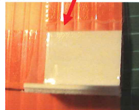
⑥取り付け部材は セロテープでしっかりと 固定(全箇所)
