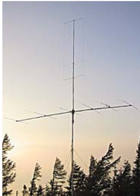
12mH の 6el Yagi とその上に付けた 15mH のヘンテナ
