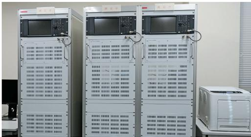
◀90kHz～30MHzの範囲の電波スペクトラムデータを収集し記録する電波スペクトル自動記録装置
