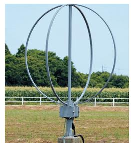
▲センサ局のループアンテナの例
