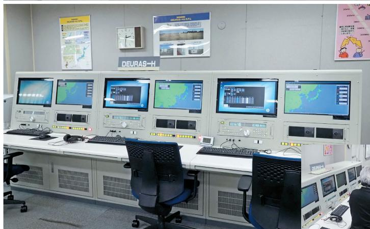
◀ DEURAS-Hの集中センタ局操作卓。全国5か所のセンタ局や地方センタ局を遠隔操作し電波の発射地点を特定できる
