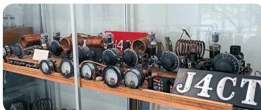
▲J4CT/JH4GGN 堀野氏が1935 (昭和10) 年に製作した7/14MHzCW送信機
