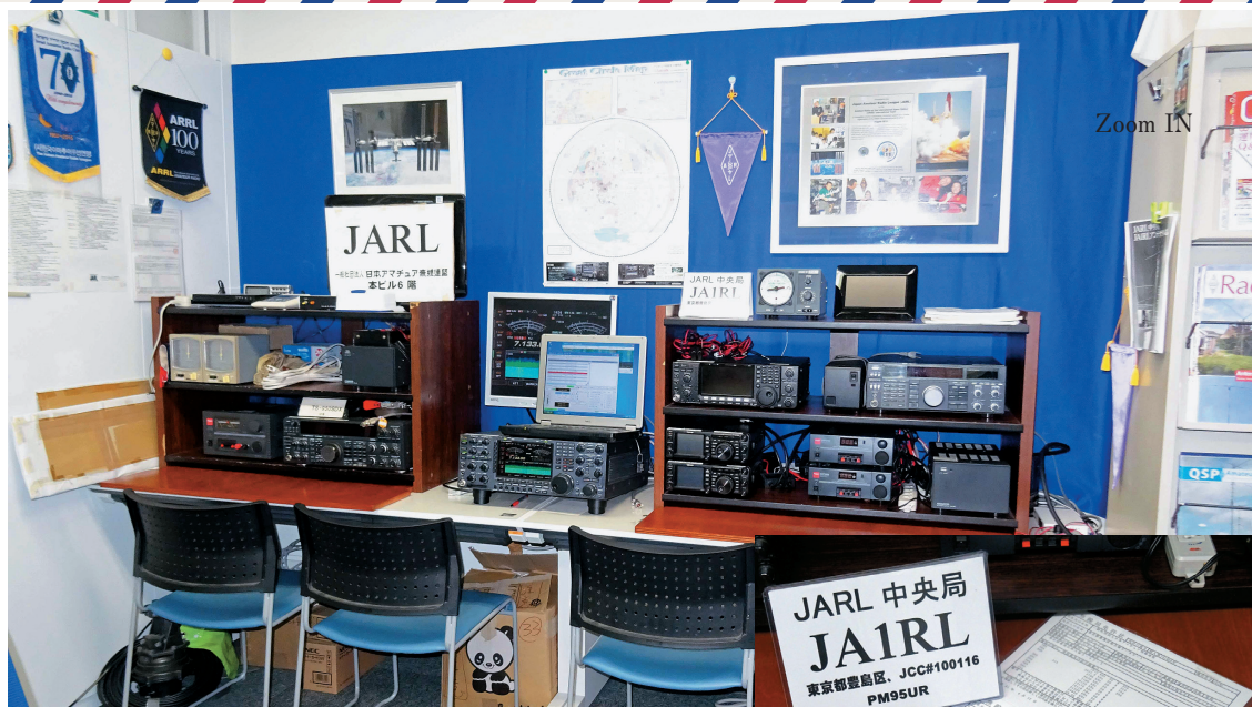
▲JARL中央局「JA1RL」のシャック。HFと50MHz帯はIC-7800やFT-991AMなど、また144/430/1200MHz帯はTS-790などでカバーしている
